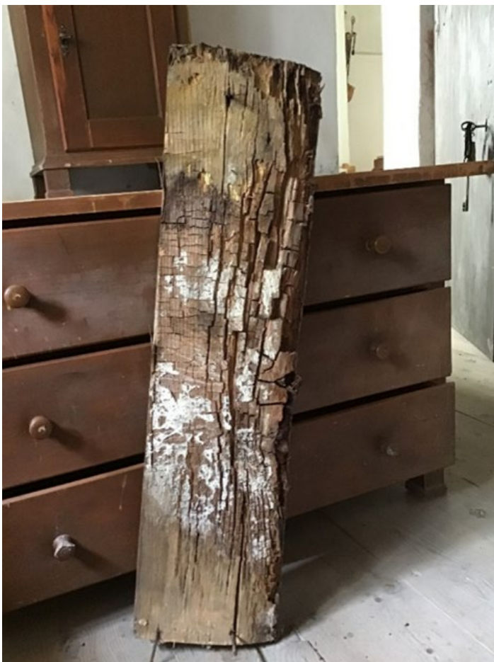
Bild: Detailaufnahme Bodenbelag aus der Bodenöffnung in der Sakristei > liegt direkt am Erdreich auf
