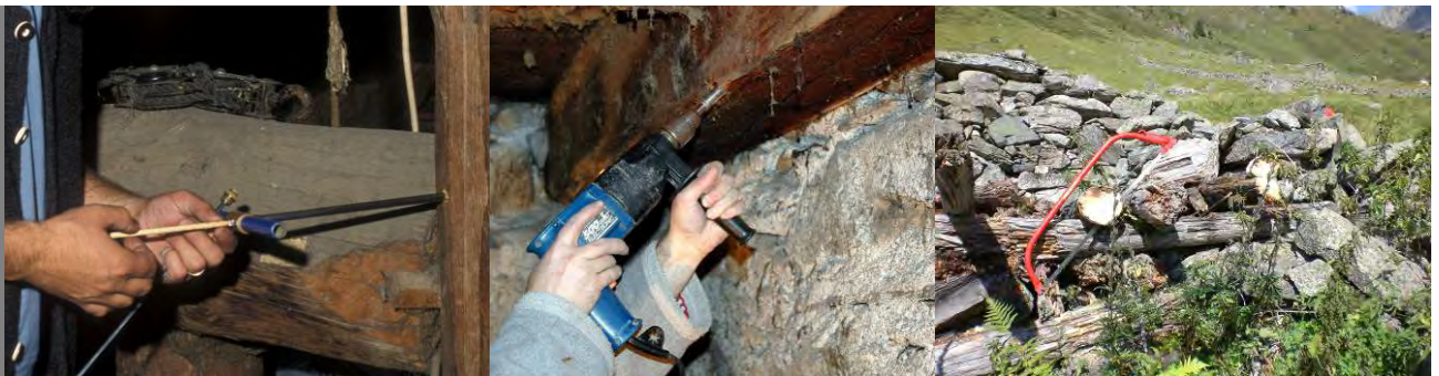
Schlüssel zum Bauarchiv – Probenbergung (Hohl-/Fräsbohrer, Bügelsäge)
