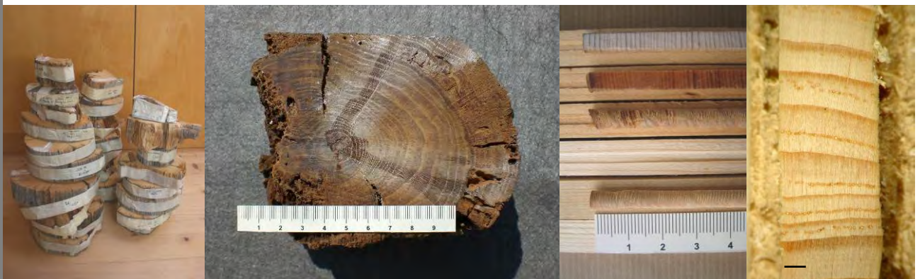
Kappstücke – Hölzer von Bargaruinen; präpariertes Kappstück; Probenmontage und Lupenbild eines auf einem Träger fixierten Bohrkerns 10 (Fichte); Maßbalken ~ 1 mm
