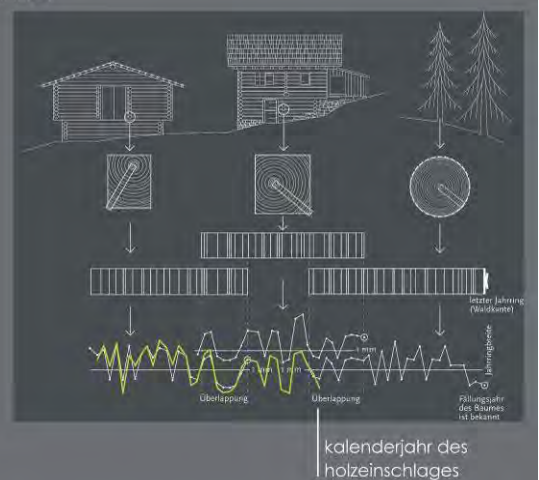
Schematische Darstellung des Überbrückungsverfahrens zum Aufbau langer Jahrringfolgen mit synchronisierter Mess-Serie (gelb)
